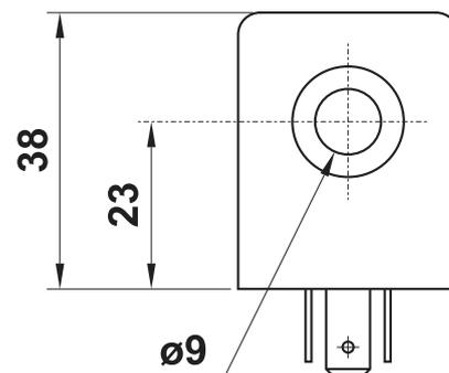
Per montare questo tipo di bobine sulle valvole Namur occorre acquistare il distanziale **01.055.2** (pag. 319) che deve essere montato sotto la valvola, in modo da alzarla creando lo spazio necessario alla bobina da 30 mm.
