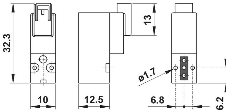
Attenzione: momento massimo di serraggio delle viti di fissaggio degli elettropiloti sulla base: 0.25 Nm
